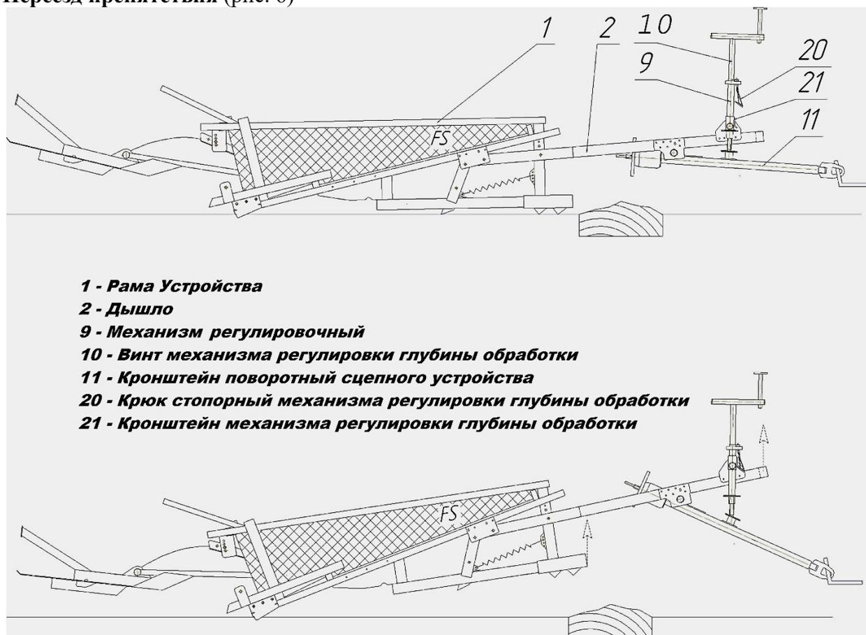
При необходимости переезда препятствия оператор поднимает конструкцию за дышло (2), при этом происходит зацеп крючка (20) регулировочного механизма (9) за отогнутую пластину направляющего кронштейна (21), тем самым поднимая режущие элементы над поверхностью обработки (препятствия), с опорой на край рамы в виде профилирующей гребёнки.
