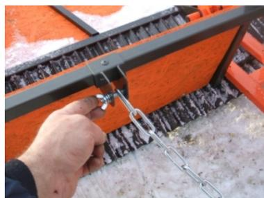
Вставьте рычаг в кронштейн подъёма (срез рычага направлен вниз).
