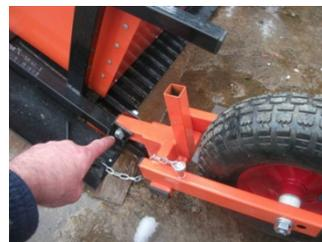
При рабочем положении Устройства поднимите колесо и установите фиксирующий пруток в стопорное отверстие
