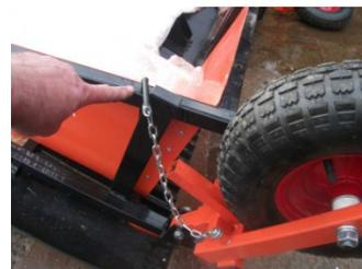
При транспортном положении Устройства фиксирующий пруток устанавливается в нижние отверстия пластины рамы транспортного колеса
