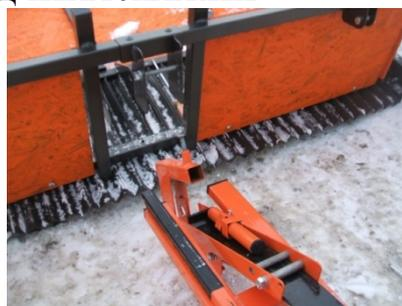
Заведите направляющие укладчика, рычаг с установленной рессорой и подъёмный кронштейн в проём транспортной площадки.
